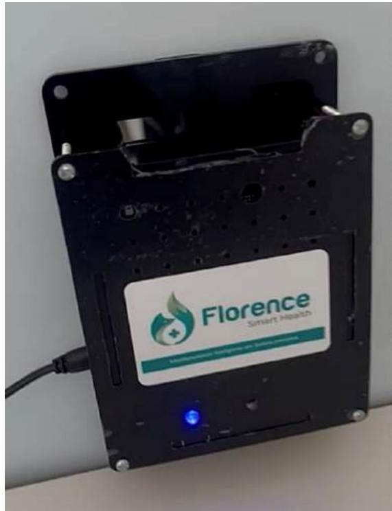
Figura 1 – Dispositivo Multiparamétrico de Análise Ambiental (Vista frontal)
